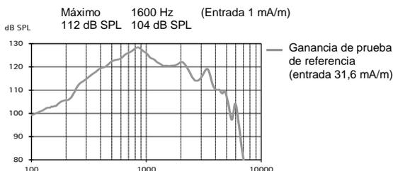
El uso de mediciones de tonos puros con un audífono digital pueda dar lugar a una respuesta de frecuencia en forma de onda. Sin duda, se trata de un efecto molesto que se produce al utilizar una señal de entrada de banda estrecha y no pueda considerarse como reflejo del rendimiento real del dispositivo con señales de entrada de banda ancha.
